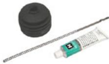
Achsmanschetten-Set Radseite (Scharniergelenkwelle)
