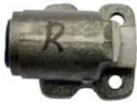
Radbremszylinder vorn rechts
