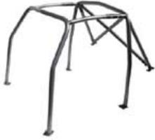
Überrollkäfig mit Kreuzstrebe, Stahlrohr, Hauptbügel verstärkt
