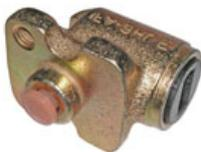
Radbremszylinder vorn links original
