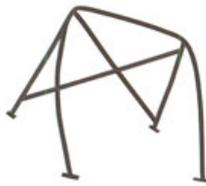
Überrollbügel mit Kreuzstrebe, Stahlrohr
