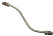
Bremsleitung 1-Kreis, vorn rechts außen, Simplex-Bremse
