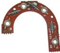
Zusatzdiodenplatte Drehstrom - Lichtmaschine
