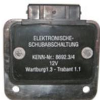
Steuerteil für Schubabschaltung (T1.1/W1.3)
