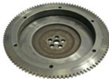
Schwungrad für Wartburgmotor mit Trabant Getriebe
