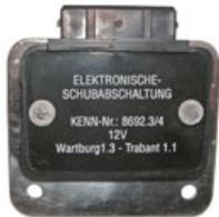
Steuerteil für Schubabschaltung (T1.1/W1.3)
