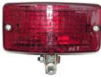
Nebelschlussleuchte, rot ( auf Stoßfänger montiert )
