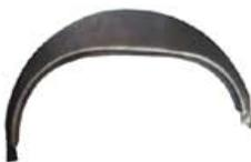
Radkasten 1/4 Schale zum Aufschießen hinten links
