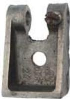
Scharnierteil für Motorhaube ( Aluminium )
