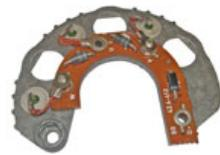
Diodenplatte Drehstrom - Lichtmaschine
