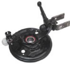
Schwenklager links, neue Ausführung \*Ausbaustufe 1\*
