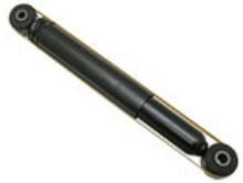
Gasdruck-Stoßdämpfer für Hinterachse Sharan/Alhambra/Galaxy (1 Paar)
