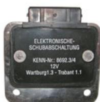
Steuerteil für Schubabschaltung (T1.1/W1.3)
