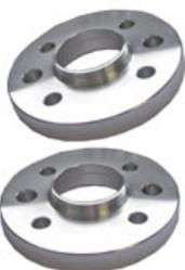
Spurverbreiterung 17mm 4x98 (34 mm pro Achse)
