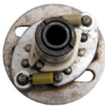
Fliehkraftversteller für Unterbrecherzündung, komplett
