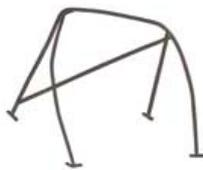
Überrollbügel mit Diagonalstrebe, Stahlrohr
