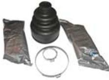
Gummimanschettensatz Getriebeseite \*klein\*
