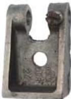
Scharnierteil für Motorhaube ( Aluminium )
