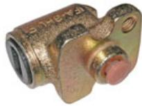
Radbremszylinder vorn rechts original
