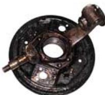
Schwenklager links, neue Ausführung
