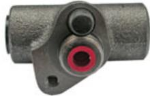
Radbremsszylinder hinten D=19,05mm
