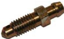
**Entlüftungsschraube für RBZ hinten - Bremssattel vorn**
