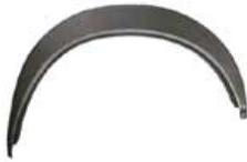
Radkasten 1/4 Schale zum Aufschweißen vorn rechts
