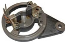
Lagerschild Lichtmaschine alte Ausführung
