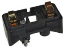
Anschlußstück Lichtmaschine alte Ausführung
