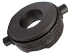
Kupplungsausrücklager W353 bis 6/ 1985; B1000 bis 02/ 1985
