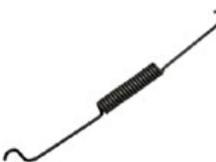
Rückzugsfeder lang für Bremsbacke
