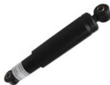
Tuning-Stoßdämpfer Hinterachse 40mm gekürzt
